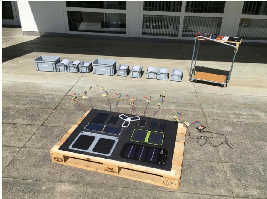
**Figure 2 PV modules posé à plat au sol (0°)**
