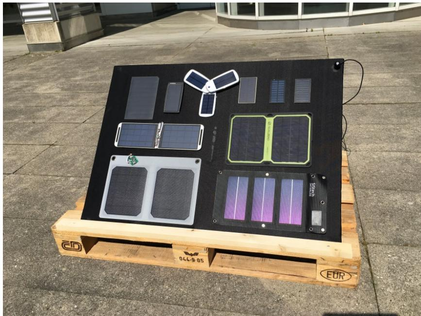
Figure 1 PV modules posé à 45°
